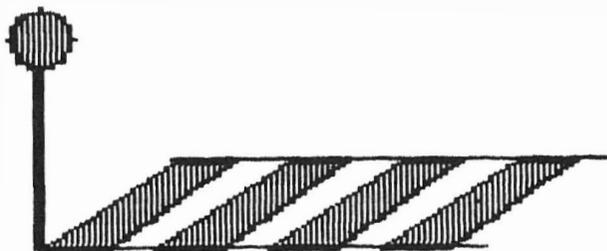
Fig. 8.15 Bandas en «cebra» generadas cuando el dibujo está creado en PMODE 3 e impreso en PMODE 4.
